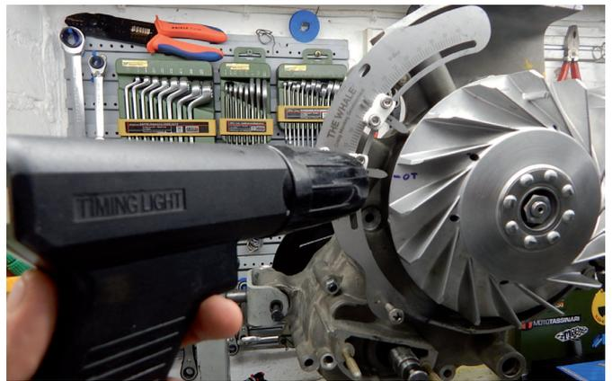
Sollte beim Abblitzen der mit der Messspitze am Wal eingestellte Zündzeitpunkt (ZZP) nicht mit der OT-Markierung auf dem Polrad übereinstimmen, so muss das Polrad demontiert und die Zündgrundplatte entsprechend verdreht werden. Dieser Vorgang wird so oft wiederholt, bis die OT-Markierung mit der am Wal eingestellten Markierung übereinstimmt.
