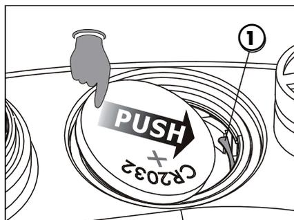
Um die neue Batterie ordnungsgemäß einzusetzen, diese wie in der nebenstehenden Abbildung angezeigt so schieben, dass die Batterie unter der Metalltasche (1) platziert wird.
