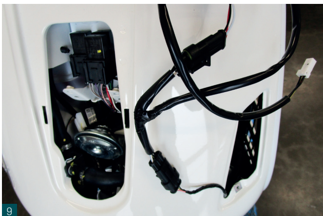
9 Bei Fahrzeugen von Bj. 2014-2018: Adapter für Tagfahrlicht einfügen. For scooters with year of construction from 2014 to 2018 use adapter for daytime running lights.
