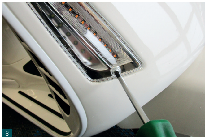
8 Einen Blinker vorne lösen. Unscrew a front indicator.
